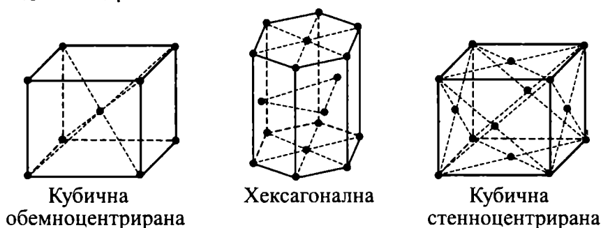
Фиг. 104. Елементарни клетки на метални кристални решетки
